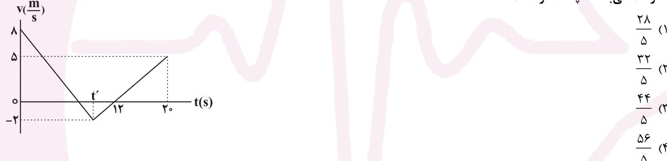
۱۹۰- مطابق شکل زیر، متحرکی مسیر مستقیم A تا B را با شتاب ثابت و بدون تغییر جهت طی می‌کند، فاصله A تا B چند متر است؟
